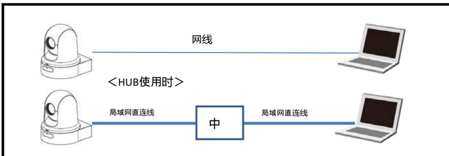
\* 通过交换 HUB 连接时, 请使用 LAN 直连电缆。
